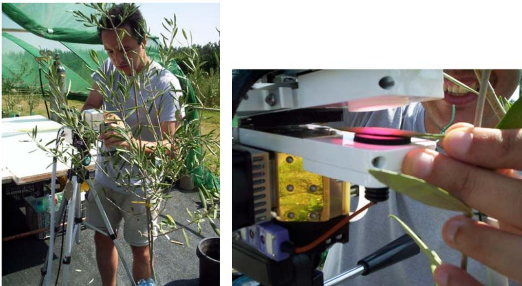
**Immagine 2.3** – Misurazione degli scambi gassosi e della fluorescenza della clorofilla effettuate con il Li-Cor 6400.
