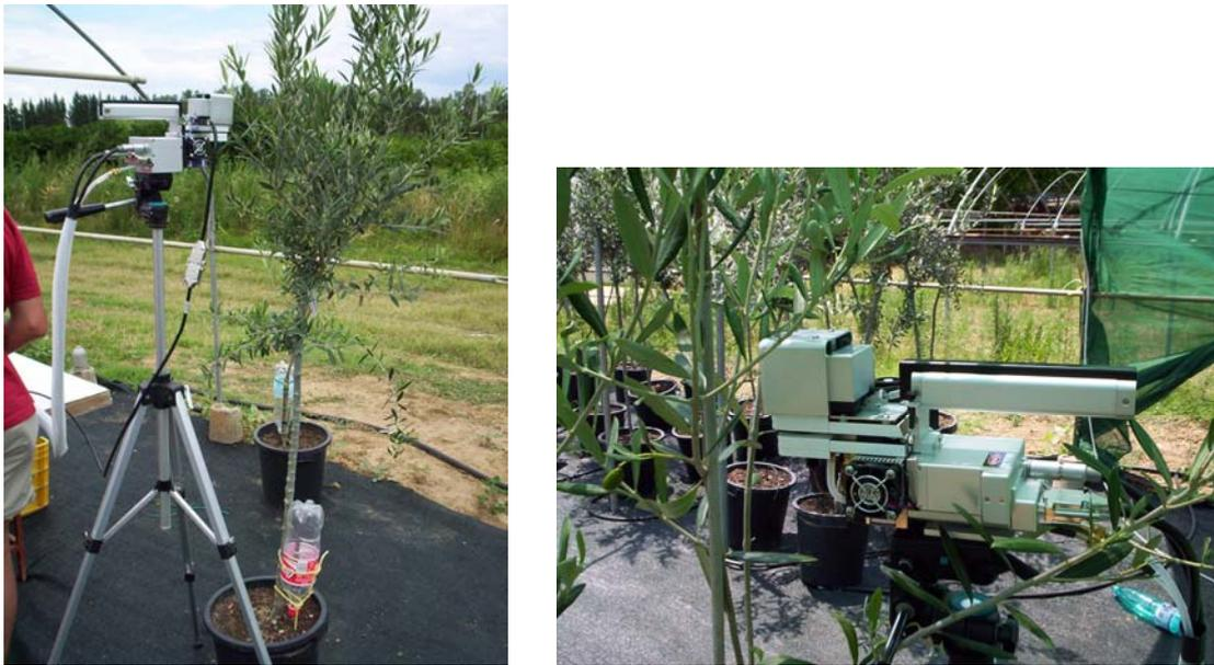
**Immagine 2.4** – Curve di risposta alla luce e curve di rilassamento della fluorescenza effettuate con il Li-Cor 6400.
